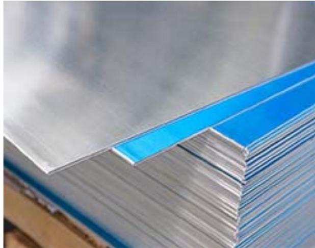
diferentes temperaturas son buenos y el alargamiento es relativamente grande. Tiene una excelente soldabilidad, están disponibles soldadura con gas, soldadura por arco, soldadura por puntos de contacto y soldadura con alambre, buena soldabilidad. La placa de aluminio 6063 es una aleación de extrusión típica. Los perfiles de aluminio 6063 son muy utilizados en perfiles de construcción, tuberías, vehículos, muebles, varillas, perfiles para ascensores, etc.
